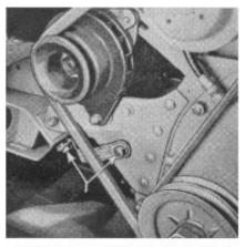
FIG. 10 -- ENGINE GROUND STRAP AND CONNECTOR
